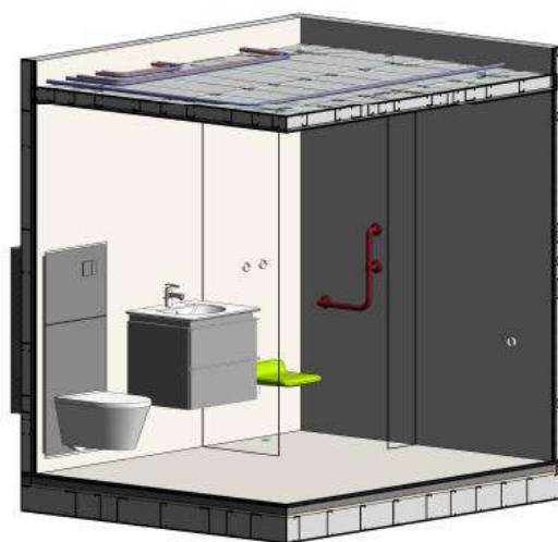
Fig. 1 Wetmodule leveres komplett med flis på gulv og vegg Figur: Wetmodule AB
